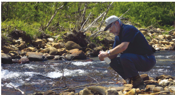
arriba Carson Gibson, operador de la depuradora de aguas residuales de la fábrica de Baxter en Marion, Carolina del Norte, EE.UU., recoge muestras del agua del río corriente abajo del lugar donde la fábrica vierte sus aguas residuales depuradas.
